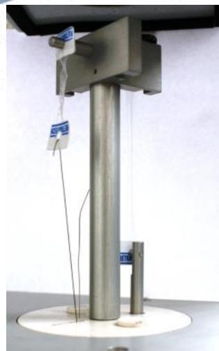
Un four est alors abaissé (température et durée sont ajustables) sur les éprouvettes simulant le temps de passage dans un tunnel de rétraction. Force, déplacement et température à proximité de l'échantillon sont alors enregistrés.
