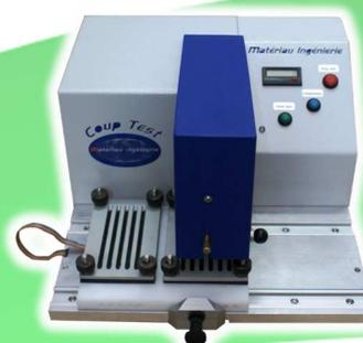
Un capotage protège les éléments sensibles ainsi que l'opérateur durant les phases de manipulation : changement de position, et changement de la lame. Le maintien en position du plateau mobile est faite par un indexeur à ressort. Enfin, un dispositif latéral garantit le maintien en position haute de la tête de coupe.
